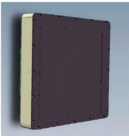
Εικόνα Β13.5 Επίπεδος ανιχνευτής ακτινοβολίας (flat panel detector-FPD).
